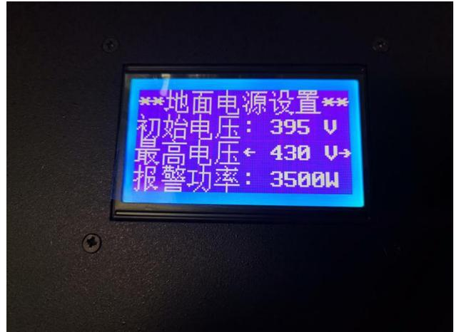
备注：建议初始电压 395v，最高电压 416V，适用于 100m5kg，≥7kg 载荷最高电压设置到 430Vdc，具体数值可根据飞机效率判断，目的是机载电池保持在合理电压范围即可，没有绝对标准。
